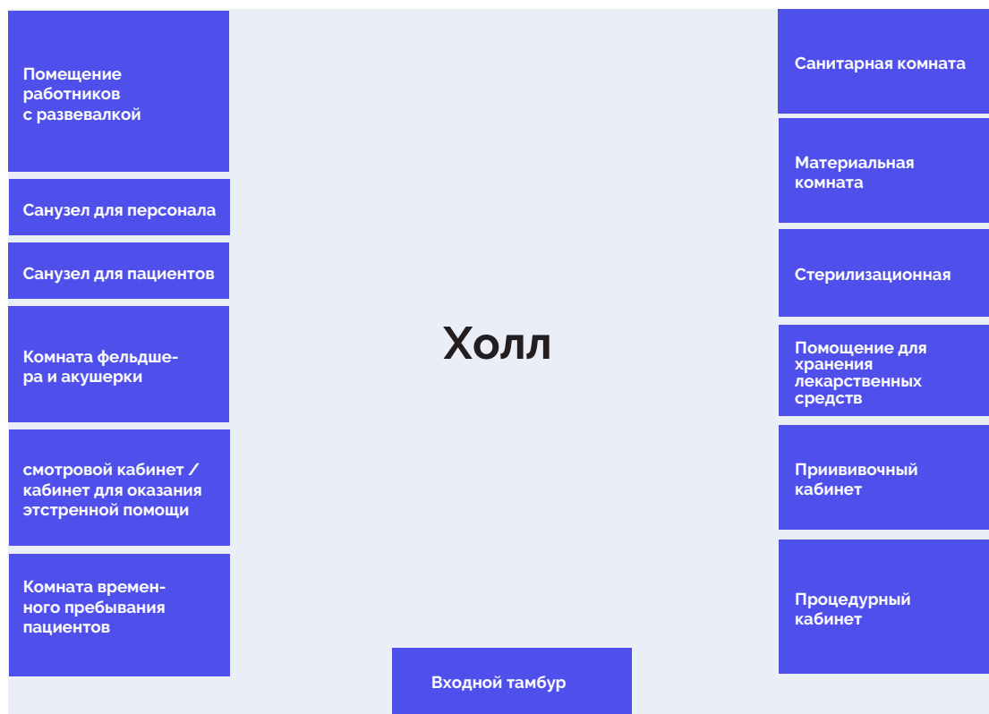
Рисунок 12 Блок-схема рекомендуемой структуры помещений ФАП с обслуживанием > 800 человек
